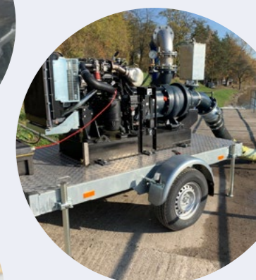
Finálny test čerpadla SPIRAM 200
